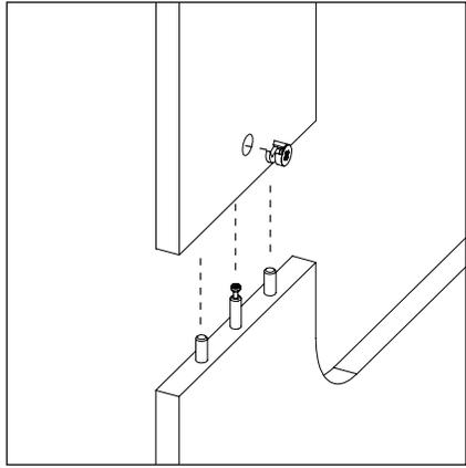
Ensamble pieza superior y respaldar con separador.
