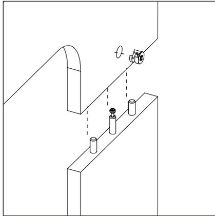
Ensamble piezera inferior y respaldar con separador.
